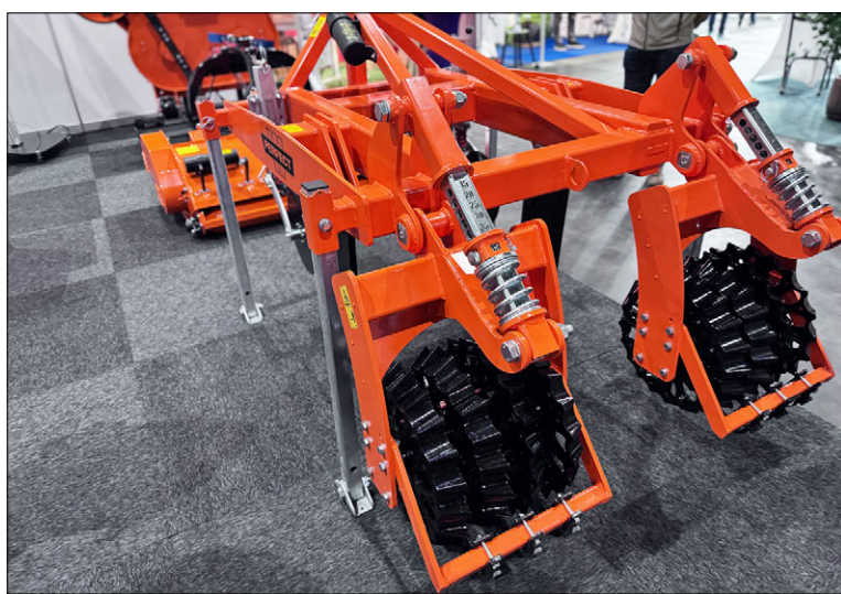
De Orionrollen drukken de graszode weer dicht. Via de rollen is ook de werkdiepte van de woeltanden in te stellen FruitMedia
