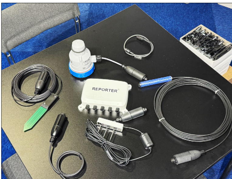
De Reporter met daar omheen diverse sensoren die op de universele gateway kunnen worden aangesloten. FruitMedia
