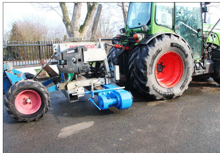
Met de Dwarse Ddwarssnijder kun je bomen dwars op de boomrij wortelsnoeien. Hiervoor demonteert je het deel met het schuine wortelsnoeimes op de wortelsnoeier van Boreco en monteert je de dwarssnijder er voor in de plaats.
