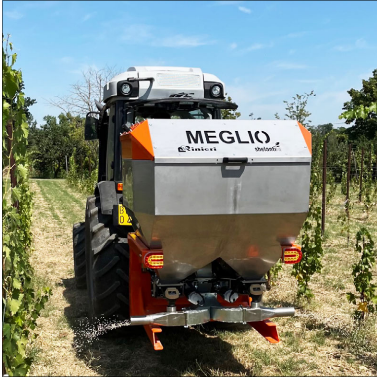
De Meglio kan een groot scala aan meststoffen zeer nauwkeurig verspreiden. Rinieri
