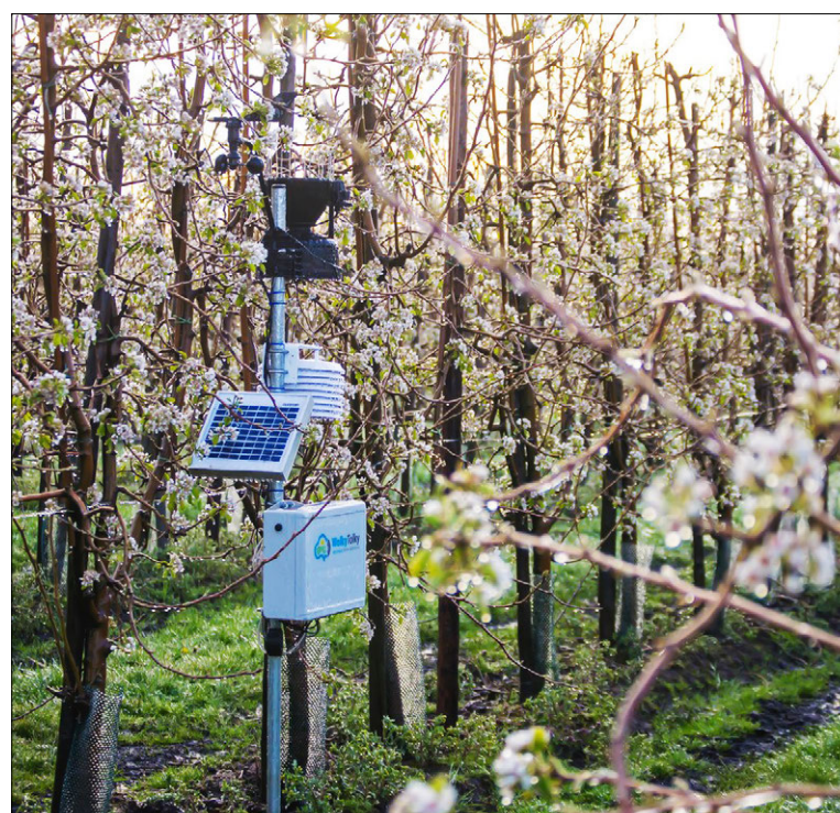
Het WolkyTolky-meetstation bestaat uit een weerstation waaraan meerdere sensoren zijn gekoppeld.
