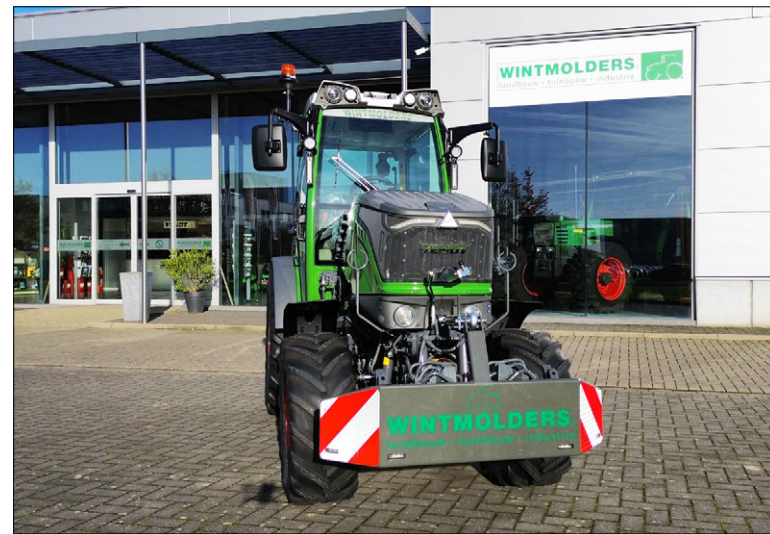
de Frontmate tractorbumper voor FENDT-smalspoorttractoren biedt ruimte aan 196 kg frontgewichten Wintmolders
