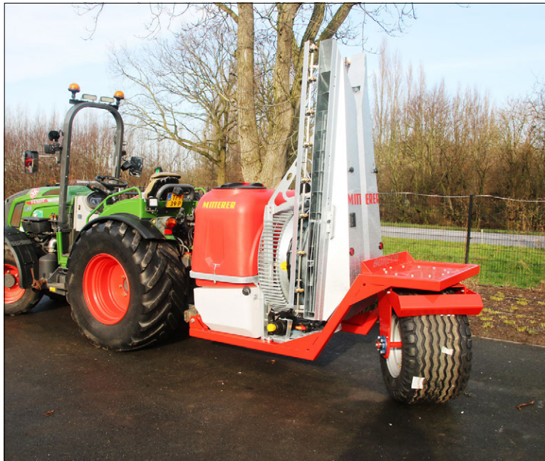
Een meerrijdend wielstel voor een gedragen spuit zorgt voor een heel betaalbare manier voor veel minder insporing onder natte omstandigheden.
