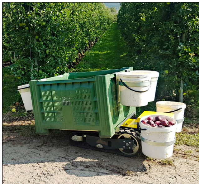
Oorspronkelijk waren de Plack platforms bedoeld om er een voorraadkist op te zetten, om direct vanaf de boom in te kunnen oogsten. Van der Linden Fruiteelt Machines
