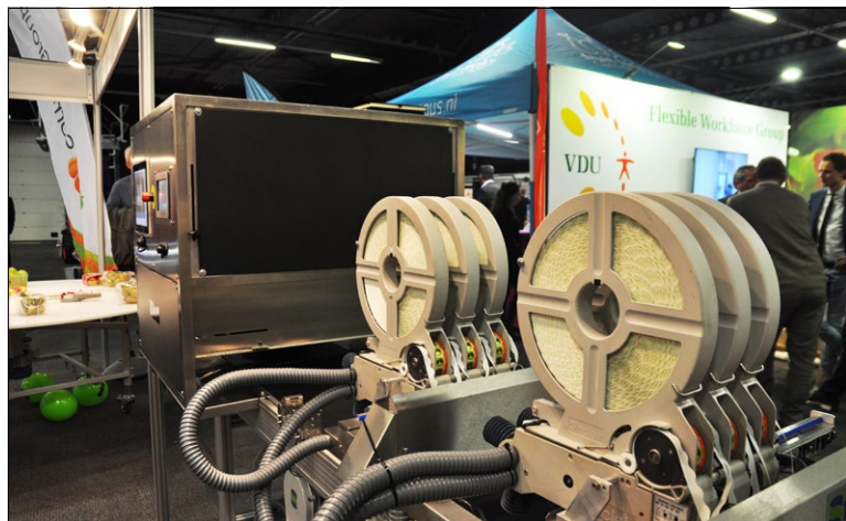
De Sinclair-stickermachine herkent het legpatroon van de vruchten op het pakblad. Arjan de Bruine
