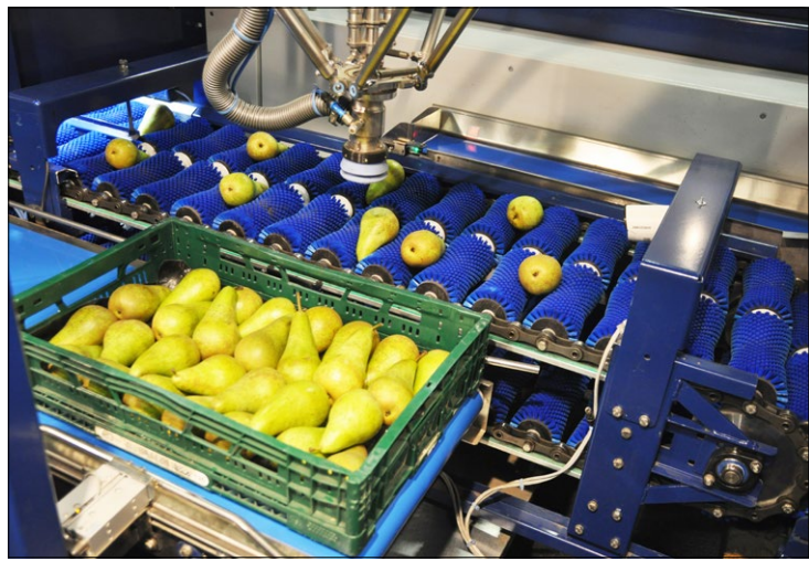
De Smart Robot Fruit Packer legt de peren met het steeltje in de juiste richting op het pakblad. Arjan de Bruine
